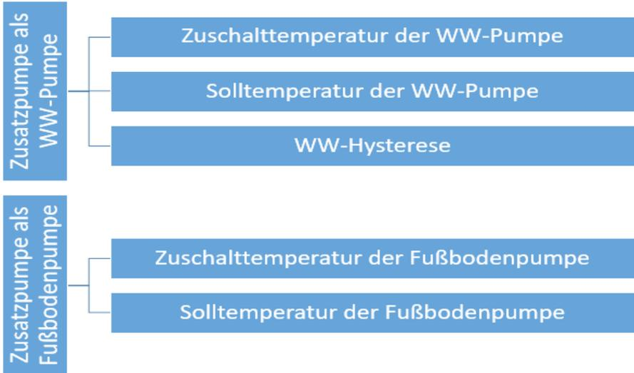
Wenn die WW-Pumpe ausgewählt wurde, dann kann ihre Einschalttemperatur geändert werden. Das ist der Schwellenwert (am zusätzlichen Sensor gemessen), bei dem sich die Pumpe einschaltet. Die zusätzliche Pumpe arbeitet solange, bis die Temperatur den Sollwert erreicht.
