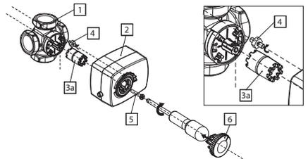
2. Installationsschema mit Wita-Ventil
