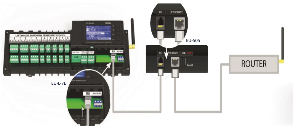
Anschlusschema des Internetmoduls EU-505
