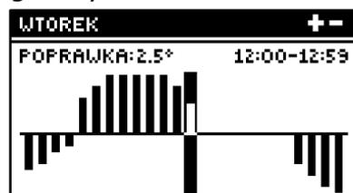
Zuerst ist der Wochentag, für den die Stundenabweichungen eingestellt werden sollen, zu wählen, und dann die gewünschte Temperaturabweichung für ausgewählte Stunde mit den Tasten <+> und <-> einzustellen. Die nächste Stunde zur Änderung wird mit den Tasten links/rechts, ausgewählt und der nächste Wert der Abweichung wird eingestellt.
