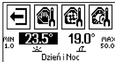
Mit dieser Funktion kann man die voreingestellte Temperatur des Kessels (ZH.) im Bereich, den die Kesselsteuerung bedient, ändern.
