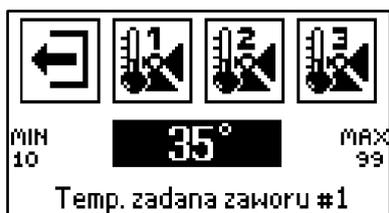
Mit dieser Funktion kann man die eingestellte Temperatur des installierten Mischventils im Bereich, den die Kesselsteuerung bedient, ändern. Wenn keine Mischventile eingesetzt werden, ist diese Funktion nicht sichtbar.
