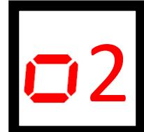
Mit dieser Option kann man die Hysterese der Pumpe einstellen. Wenn der Unterschied zwischen der Temperatur der Einstieg in Betriebszyklus (Einschaltschwelle) und der Temperatur der Rückkehr in den Stillstand (Beispiel: *die vorgegebene* Temperatur hat einen Wert von 60°C und Hysterese beträgt 3°C, Übergang zu dem Betriebszyklus erfolgt nach dem Erreichen der einer Temperatur von 60C und der Rückkehr in den Stillstand erfolgt nach der Temperatursenkung 57°C).
