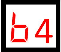
Diese Option ist nur verfügbar, wenn das ausgewählte Gerät auf die Thermostat-Funktion eingestellt ist. Der Benutzer kann einen minimalen Schwellenwert im Bereich von 0 bis 70 ° C einstellen.
